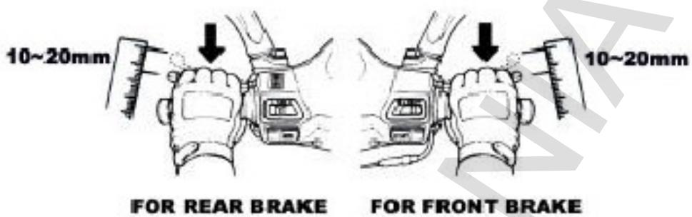
Регулировка тормоза барабанного типа.
