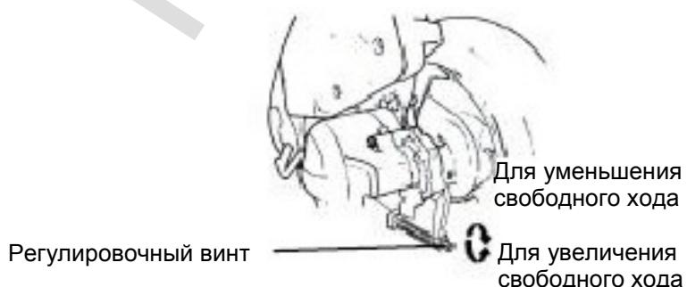
Задний тормоз барабанного типа
